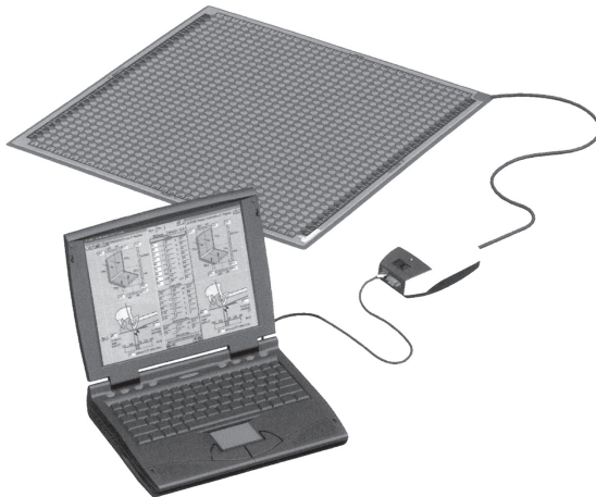
Figuur V4.11 Het SMS-zitdrukmeetsysteem.
