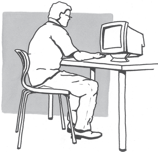
Figuur 1.5 Een naar beneden gericht blikrichting heeft een kyfoserende zithouding tot gevolg.
