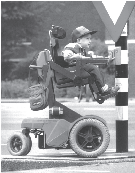
Figuur 4.22 De Skwirrel: een elektrische kinderrolstoel met hoog-laagverstelling en kantelverstelling.
