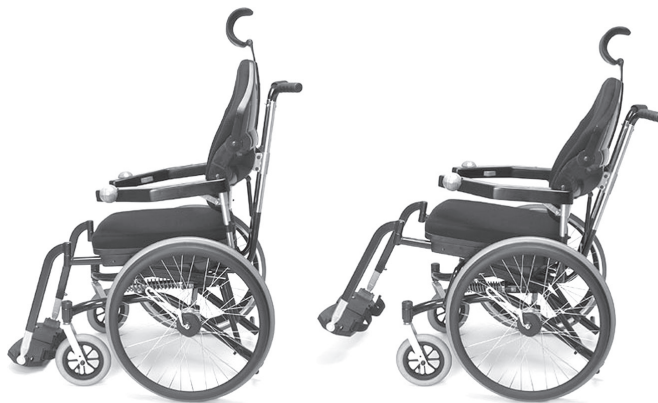
Figuur 4.28 Niet-opvouwbare rolstoel C-Rex met elektrische kantelverstelling en individueel instelbare rugondersteuning in een transferstand en in een stand met een stabiele zithouding.
