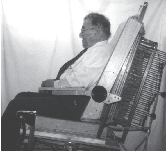
Figuur 2.19 De ontwikkelde passtoel met centrale ondersteuning van de wervelkolom door rechthoekige elementen. Let op de zichtbare curvatuur van de wervelkolom aan de achterzijde.
